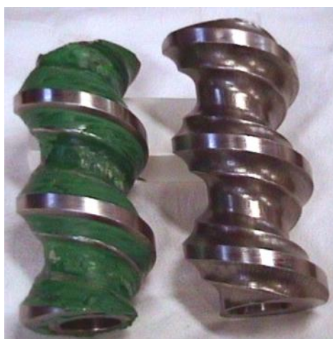
Schneckensegment vor und nach der Reinigung
