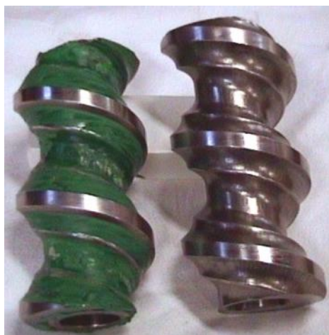
Segment de vis sans fin avant et après le nettoyage
